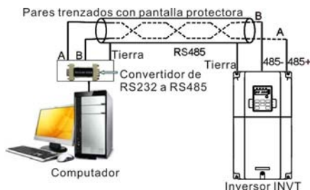
Figura1 Conexión física RS485 en aplicación única
